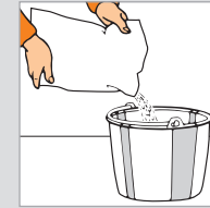
Abbeelding 23: FERMACELL voegengips in het water strooien
