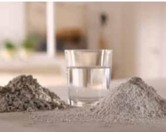
Gut zu wissen, dass es das FERMACELL Reinheitsgebot gibt: Zur Herstellung von FERMACELL Gipsfaser-Platten werden ausschließlich natürliche Materialien verwendet. Dies sind recyceltes Papier, Gips und Wasser, die unter hohem Druck zu stabilen und geruchsneutralen Bauplatten gepresst werden.
