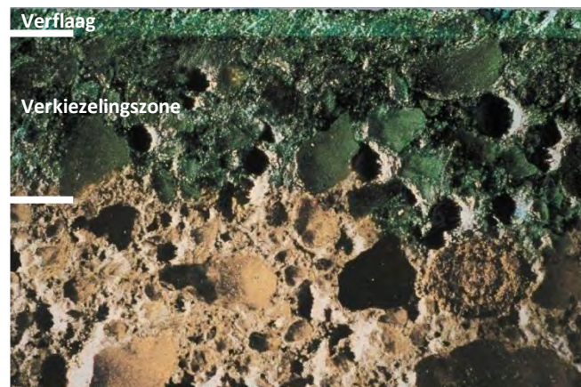
Figuur 2.8: Micro-opname waarop de indringdiepte en verkiezeling van minerale muurverf aan de oppervlakte duidelijk is te zien (Foto: Keim)
